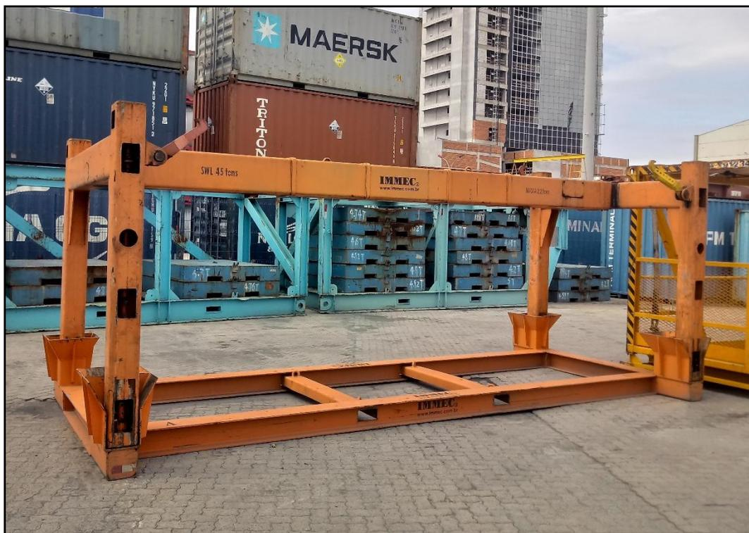
Figura 1. Spreader para carga de excesso, OHF-02.
